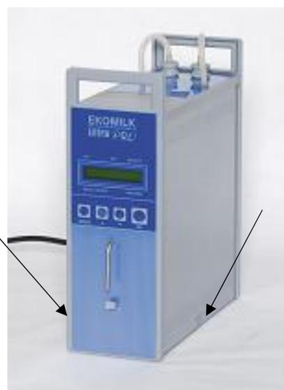
Рисунок 8 – Схема пломбировки анализаторов
